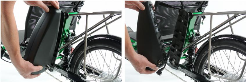
Zum Entnehmen heben Sie den entriegelten Akkupack etwa 1 cm an und dann aus der Halteplatte heraus. Zum Einsetzen setzen Sie den Akkupack 1 cm nach oben versetzt auf die Halteplatte und lassen ihn dann nach unten in die Verzahnung sinken. Verriegeln Sie ihn dann.
